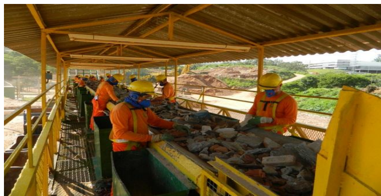
Figura 7: Mesa de triagem da usina SBR reciclagem em Jundiaí – SP. Imagem: Abrecon
