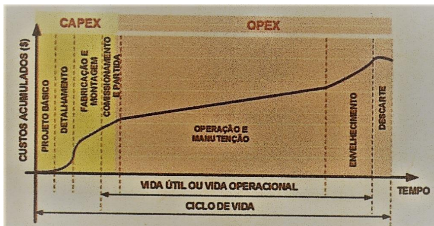
Figura 6 – Custo de Ciclo de Vida – CAPEX e OPEX (LAFRAIA et al. , 2014, p. 259)
